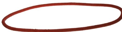
**Bitte angeben:** Die Schnurlänge entspricht der Arbeitslänge. Es handelt sich auf jeden Fall um die Schnurlänge über beide Antriebsscheiben. In Anbetracht der Elastizität werden die Riemen in freier Länge geliefert, was 10 bis 12% weniger Arbeitslänge entspricht.
